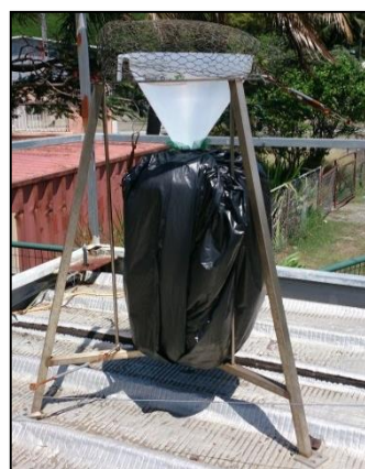
Figure 2 : Jauge Owen installée sur le toit d'une station de mesures
